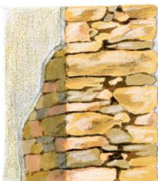
mur ancien souvent maçonné à la terre, enduits fins à la chaux (intérieur et extérieur)
