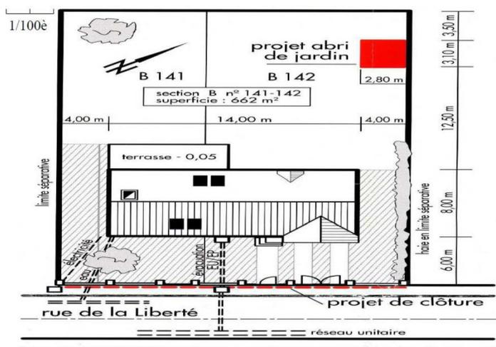
Le plan de masse des constructions à édifier ou à modifier permet de vérifier que le projet de construction respecte les différentes règles d'implantation.
