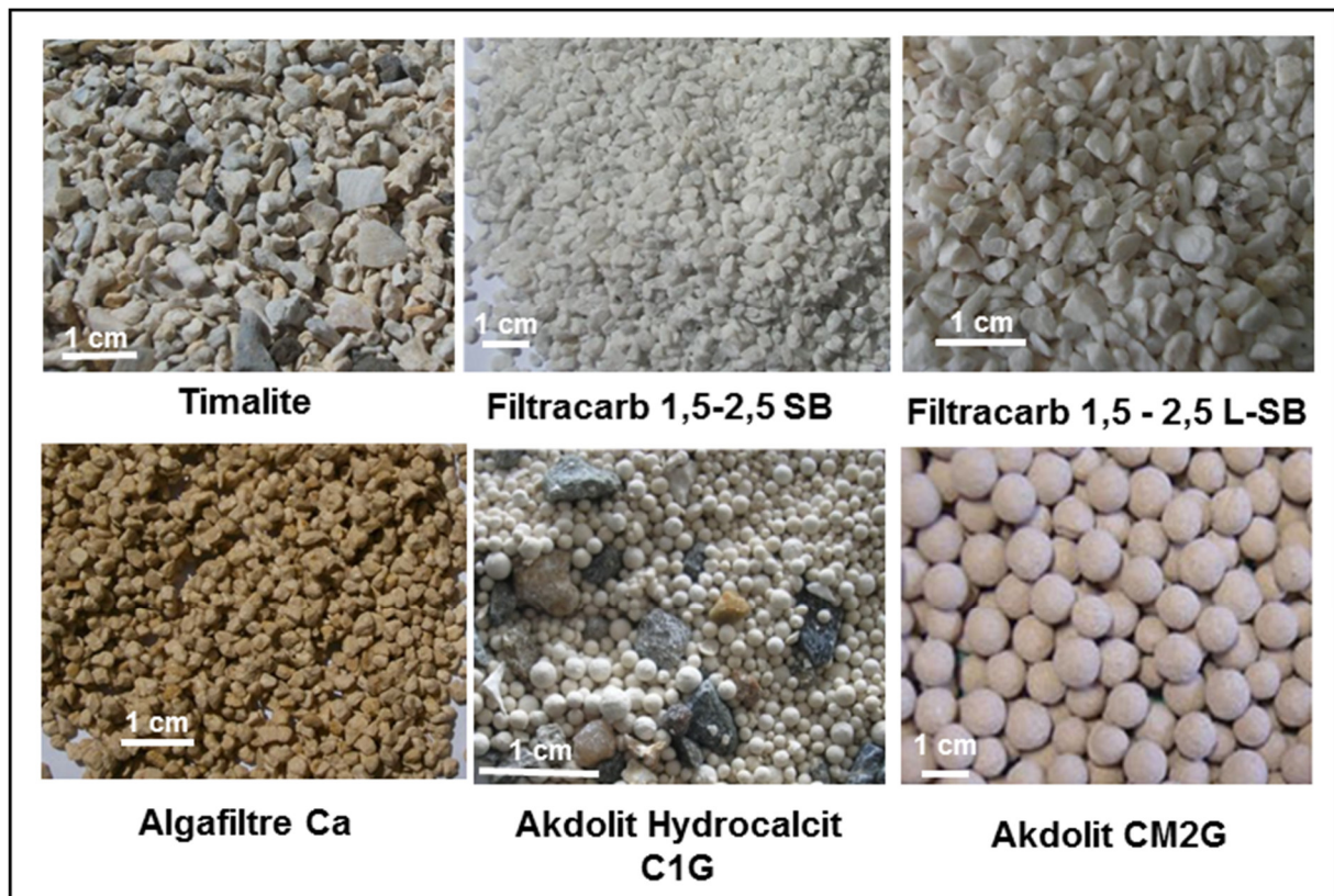
Figure 38 : Photo des principaux matériaux neutralisants utilisables
