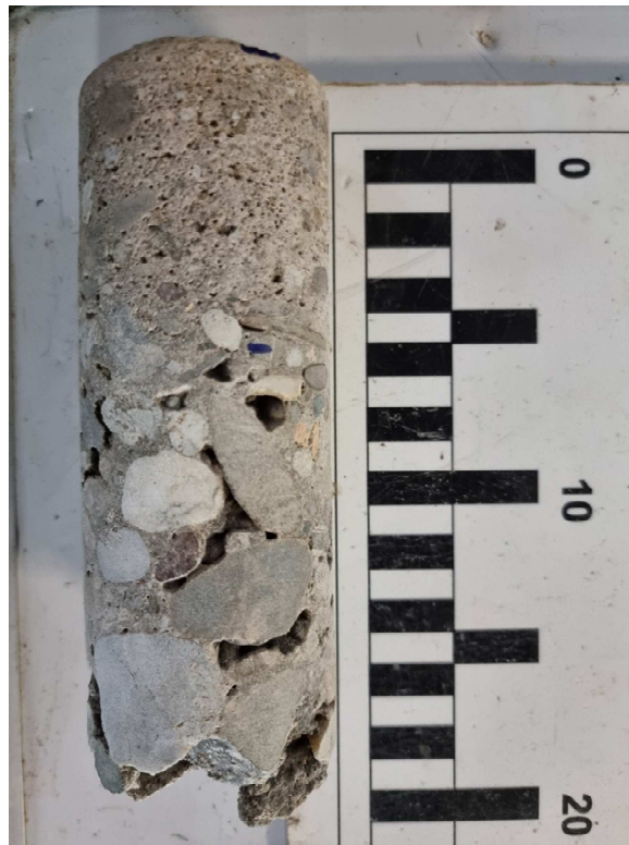
Figure : Carotte C2 de longueur 210 mm
