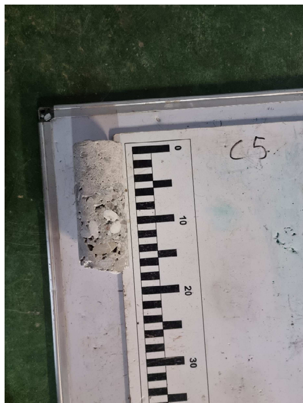
Figure : Carotte C5 de longueur 208 mm
