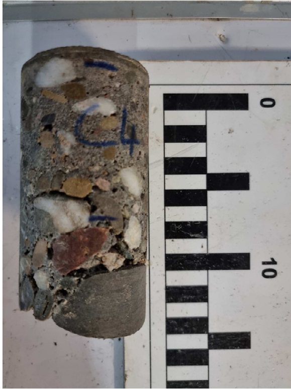
Figure : Carotte C4 de longueur 150 mm
