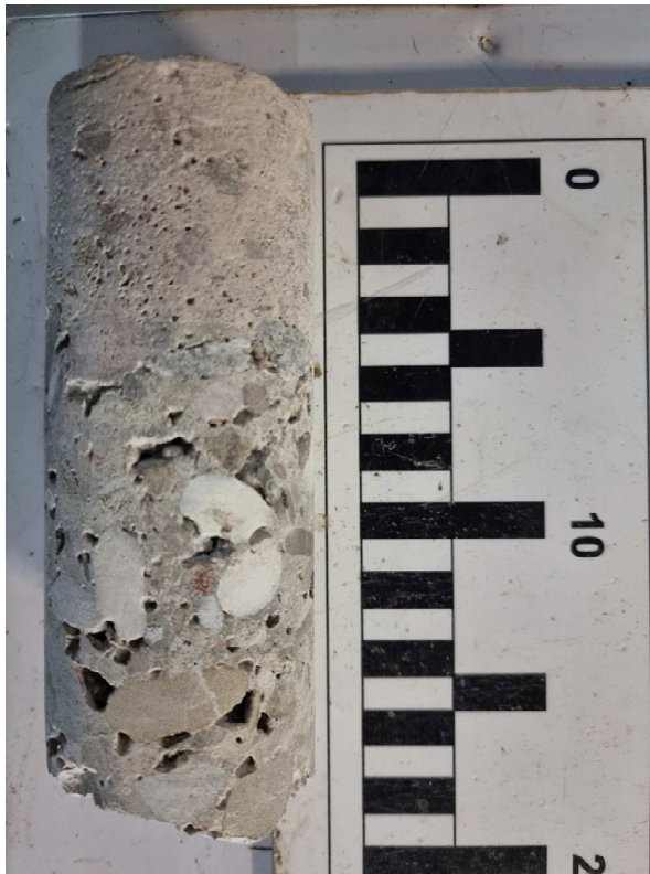
Figure : Carotte C5 de longueur 208 mm
