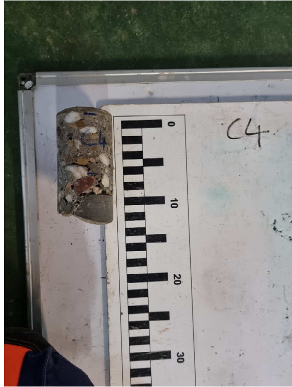
Figure : Carotte C4 de longueur 150 mm
