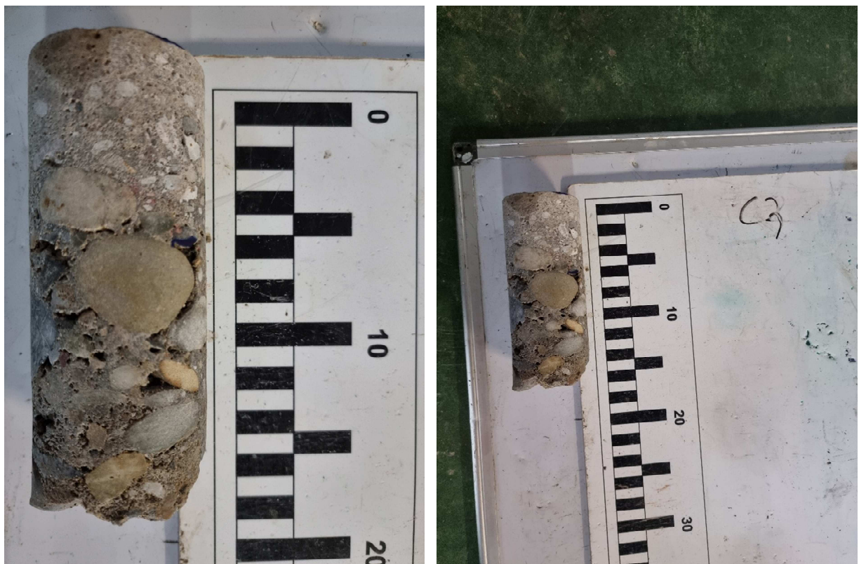
Figure : Carotte C3 de longueur 190 mm
