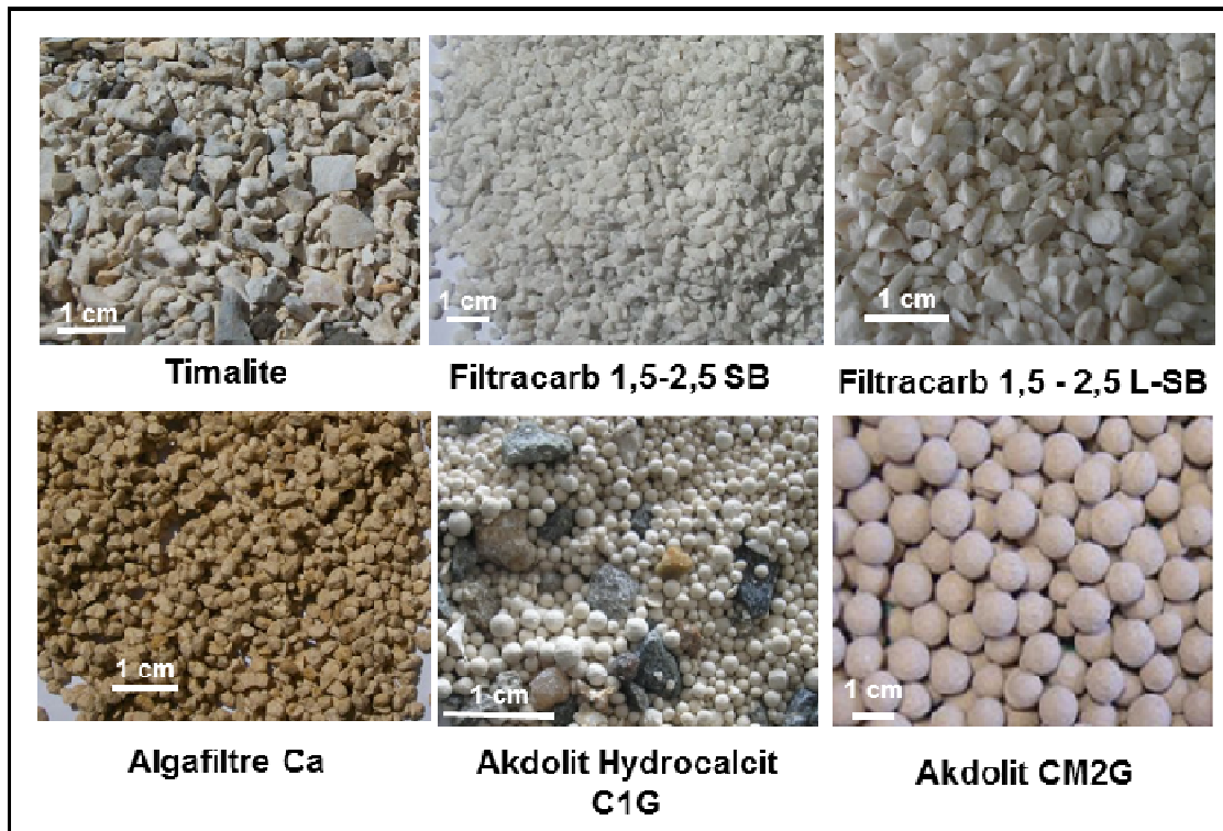
Figure 23 : Photo des principaux matériaux neutralisants utilisables
