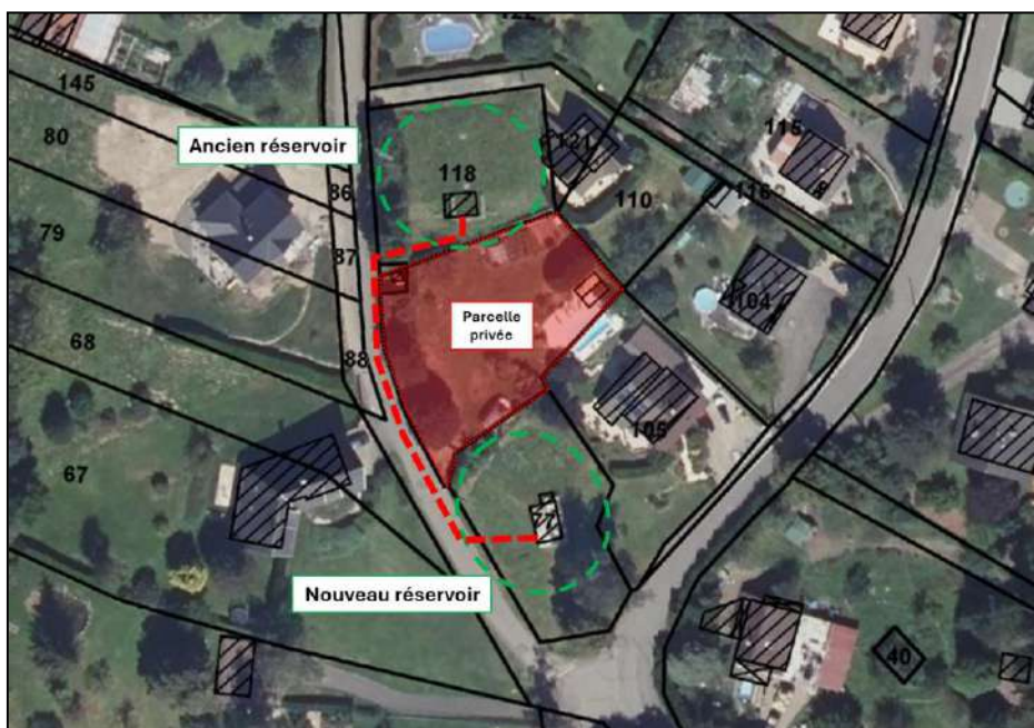
Figure 23 : Reprise de la conduite sous domaine public
