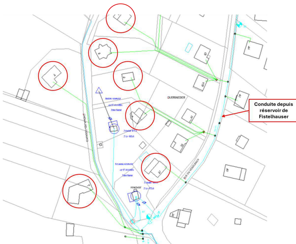
Figure 9 : Exemples d'habitations connectées à la conduite du réservoir de Fistelhauser
